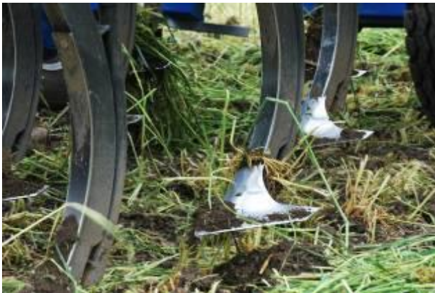
Bild 1: Durch überlappende Gänsefußschare wird der Boden auf der kompletten Breite abgeschnitten und direkt hinter dem Schar wird auf die geschnittene Tiefe das Saatgut abgelegt
