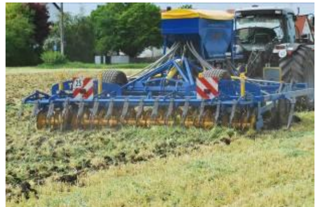
Bild 8: Gleichmäßige Verteilung des Roggenstrohs auf der gegrubberten Fläche
