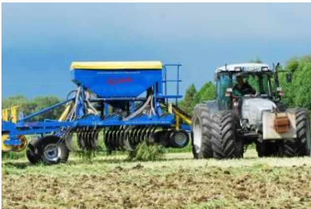
Bild 7: Enger Wendekreis von bis zu 110° mit dem aufgesattelten Trefflergrubber möglich
