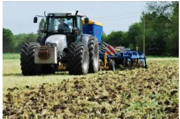
Bild 2: Zugmaschine mit aufgesatteltem Grubber; direkte Saat in Grünroggenstoppel
