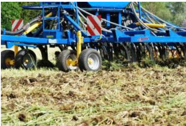
Bild 5: Exakte Tiefenführung und Tiefeneinstellung mit den doppelten Führungsrädern
