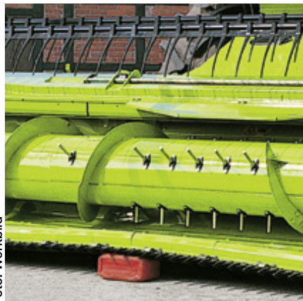
Der Messerbalken der Flexschneidwerke passt sich flexibel dem Boden an.
