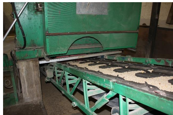
Abbildung 4: fertig getoastete Sojabohnen auf dem Transportband der Aufbereitungsanlage
