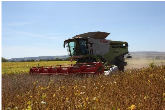
Abbildung 1: Mähdruschvorstellung mit dem Flexschneidwerk auf der Demofläche beim überregionalen Feldtag in Butteltstedt
